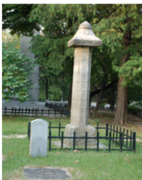
▲ 옥외 전시실에 있는 수표석 - 1441년(세종23) 정계천의 물높이를 재기 위한 수표교에 세웠던 수위 측정기로 보물 제838호로 지정되어 있다.
